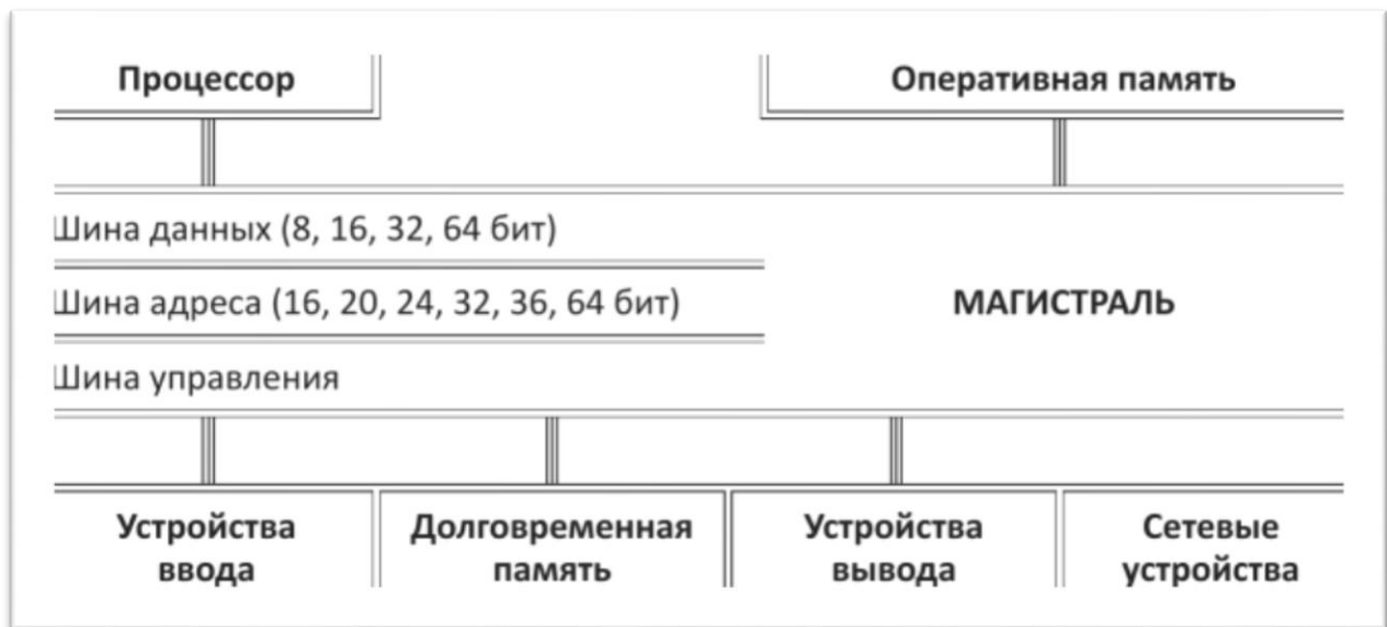
Рисунок 5 – Магистрально-модульный принцип построения компьютера
